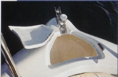
Prostor za sidreni lanac
