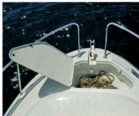
▲ Prostrano spremište za sidreni lanac i konop u samom vrhu pramca dovoljno je veliko da u njega stane i sidro
